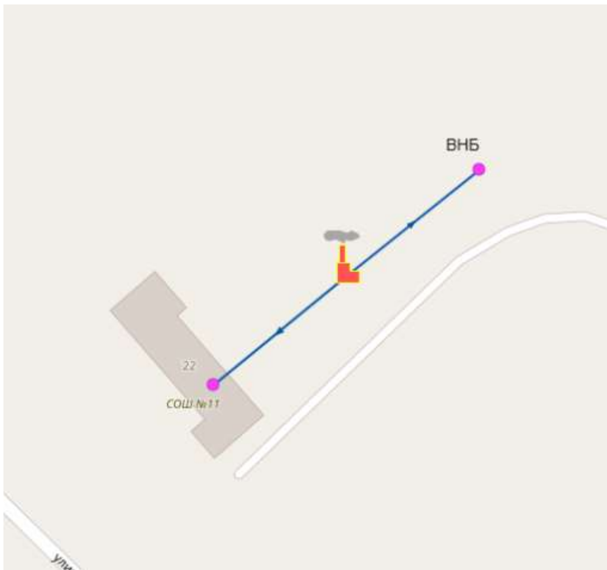
Рис.4. Схема тепловых сетей от котельной по адресу: с. Введенщина, ул. Мира, 20
