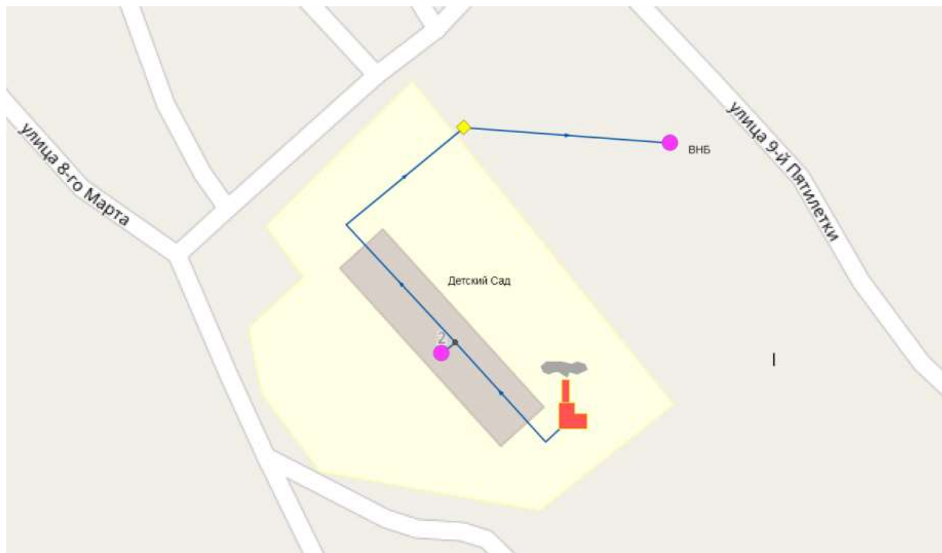
Рис.5. Схема тепловых сетей от котельной по адресу: с. Баклаши, ул. 9 Пятилетки, 2 (из электронной модели Zulu GIS 8.0)
