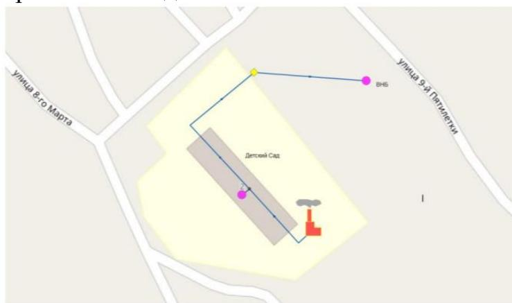
Рис. 9.2 - Схема тепловых сетей от котельной МКДОУ ШР «Детский сад № 5 «Одуванчик»
