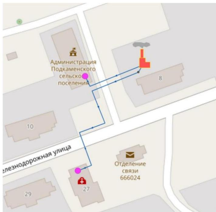
Рис. 12.2 - Схемы тепловых сетей в зонах действия котельной «Жил. массив»
