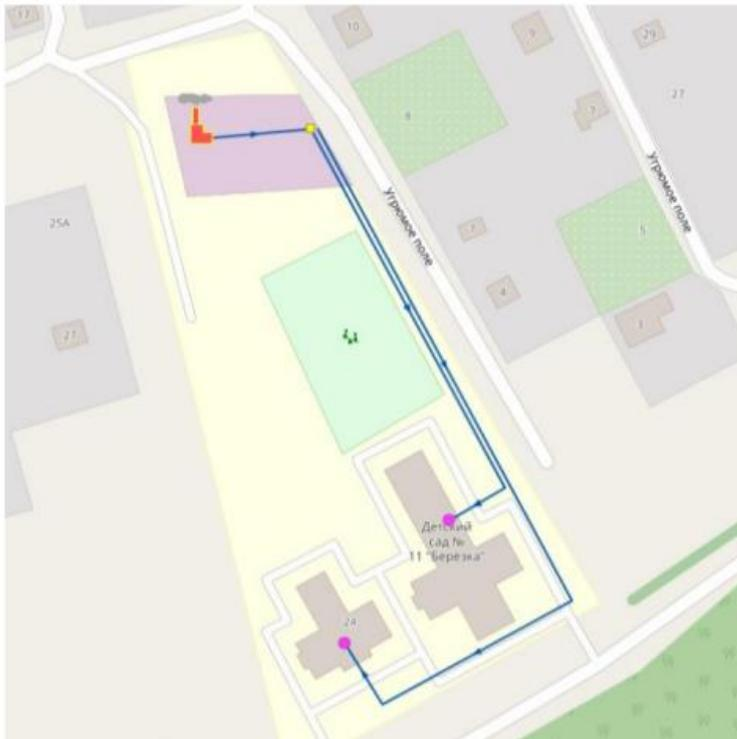
Рис.7.2 - Схемы тепловых сетей в зонах действия котельной МКДОУ ШР «Детский сад № 11 «Березка»
