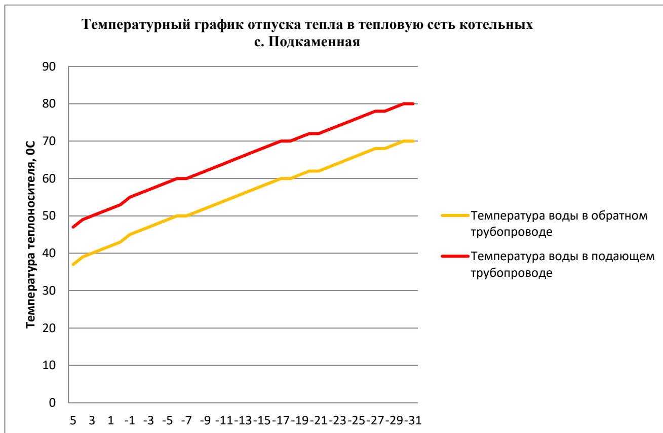
Рис. 6. Температурный график отпуска тепла от котельных с. Подкаменная
